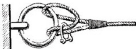
Рис. 6 Крепление огона швартова за рым скобой
